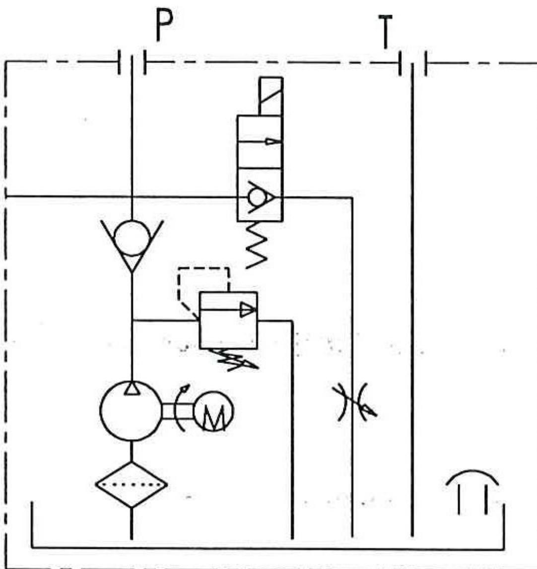
8.6 . Схема гидравлическая принципиальная
